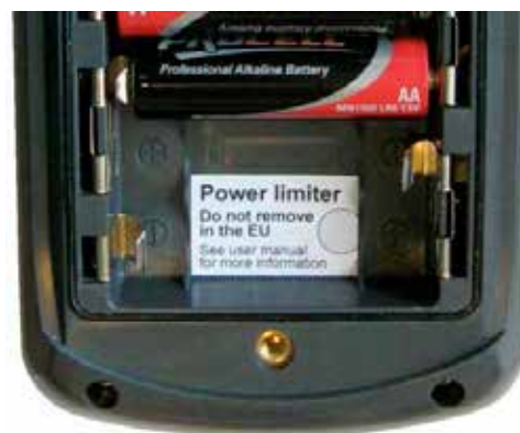
Placeringen af strømbegrænseren i batterirummet.
