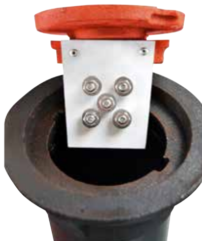
På undersiden af dækslet kan kablerne termineres og spænding tilsluttes.
